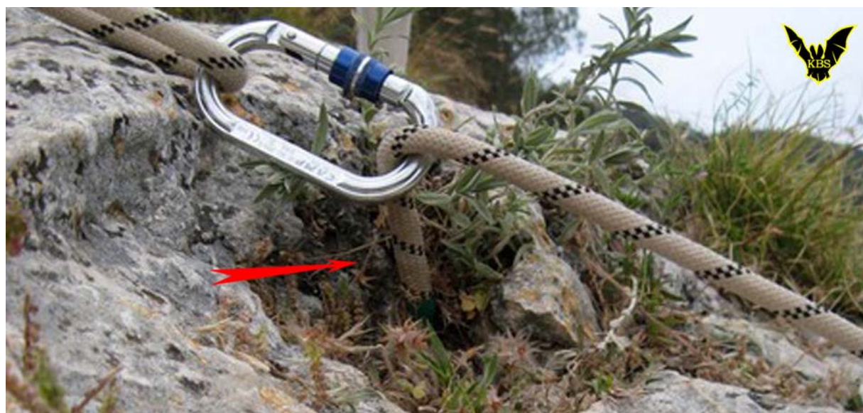
Рис.27. Застревание конца веревки с «гвоздем» при сдергивании через такое, казалось бы, бесппроблемное кольцо, как карабин. Скалодром Бейт-Орен, Израиль, 2009 год.
