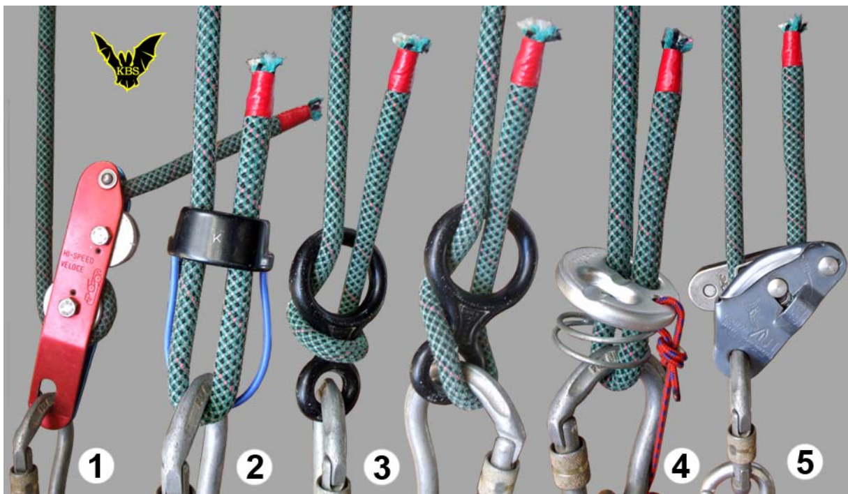
Рис. 3. Так срабатывает «гвоздь» на конце веревки при спуске на различных спуско-страховочных устройствах:
