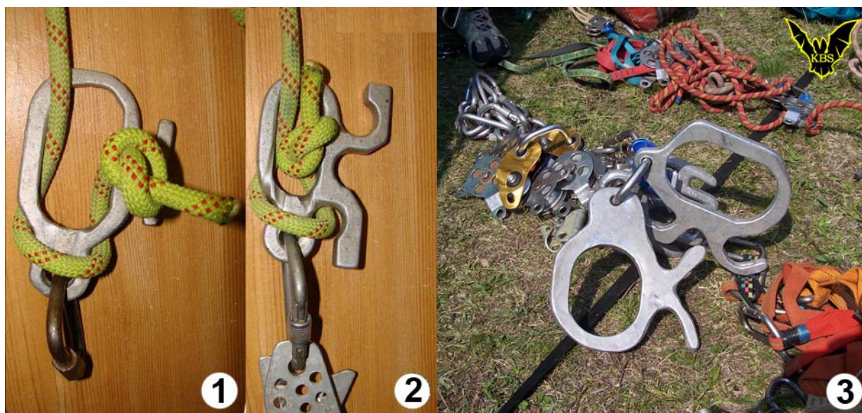
Рис.23. Рогатки самых разных размеров до сих пор широко используются в пещерах, на соревнованиях и в промальпе. 76
