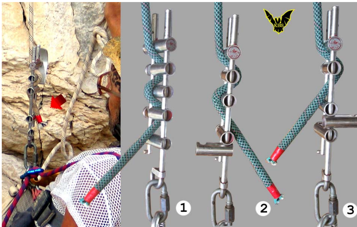
Рис.4. Азиан-рэк при разных вариантах спуска:
