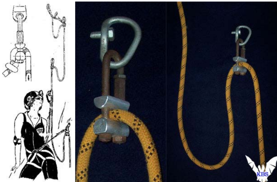
Рис.94. Карабин-амортизатор Серафимова (иллюстрация из моей работы "Автоматическая страховка в горах и пещерах")
