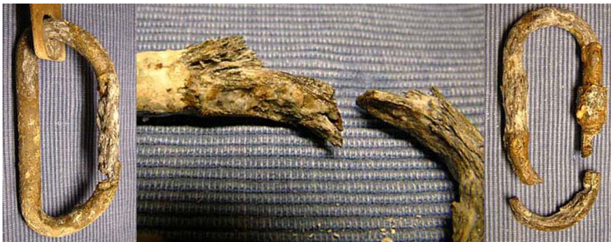
Рис.57. Фотографии корродированных карабинов из алюминиевых сплавов из статьи "Grotte des Emotions" by Paul de Bie, 2003 год.
