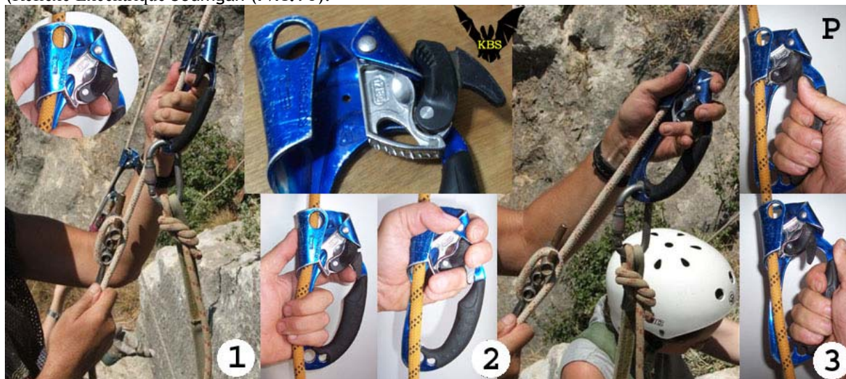
Рис.90. Самостраховочный эксцентриковый зажим с первым (еще не складным) курком "Reflex" на основе пуани Петцля.
