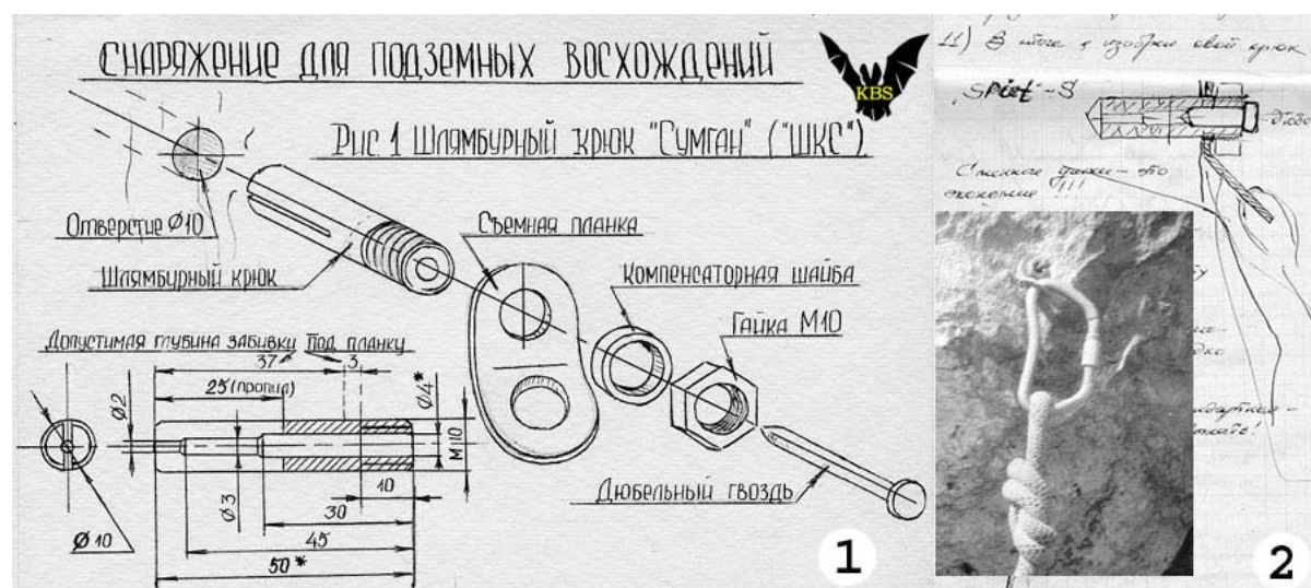
Рис.29. Шлямбурный крюк "Сумган" (ШКС) - основа первых лет освоения нами SRT
