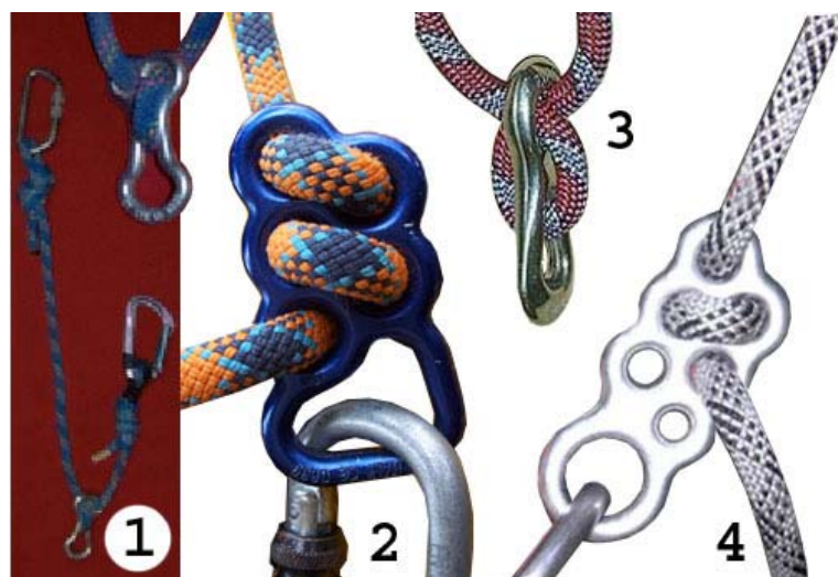
Рис.48. Фрикционные амортизаторы на самостраховочных усах.
