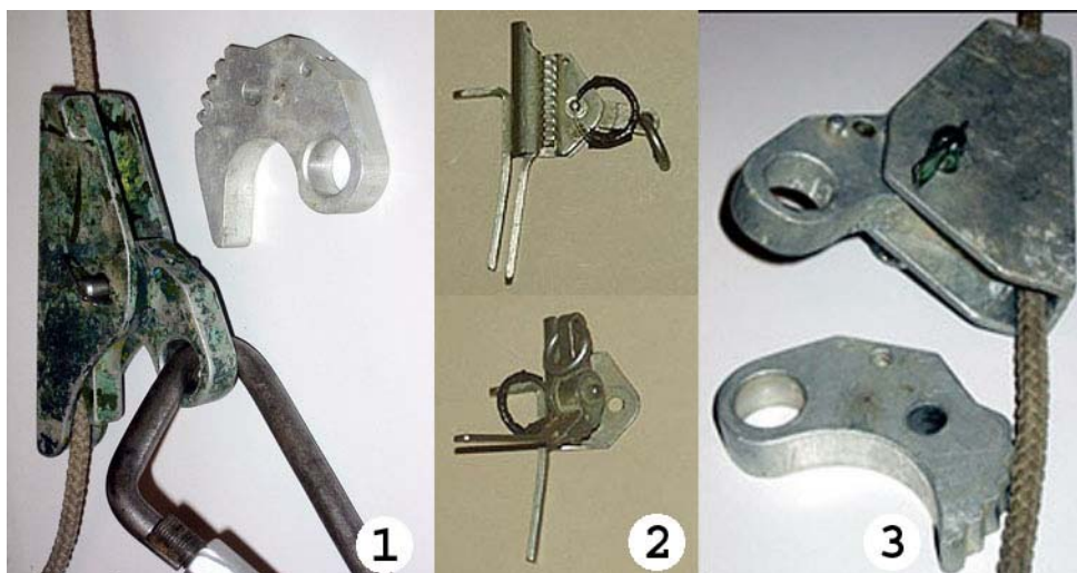
Рис.85. Самостраховочные зажимы, использующие хватательный рефлекс.
