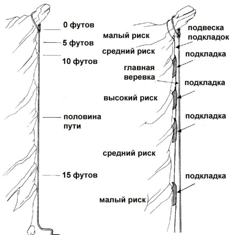
Рис.23. Оценка риска от трения и антиабразивная защита навески по правилам IRT
