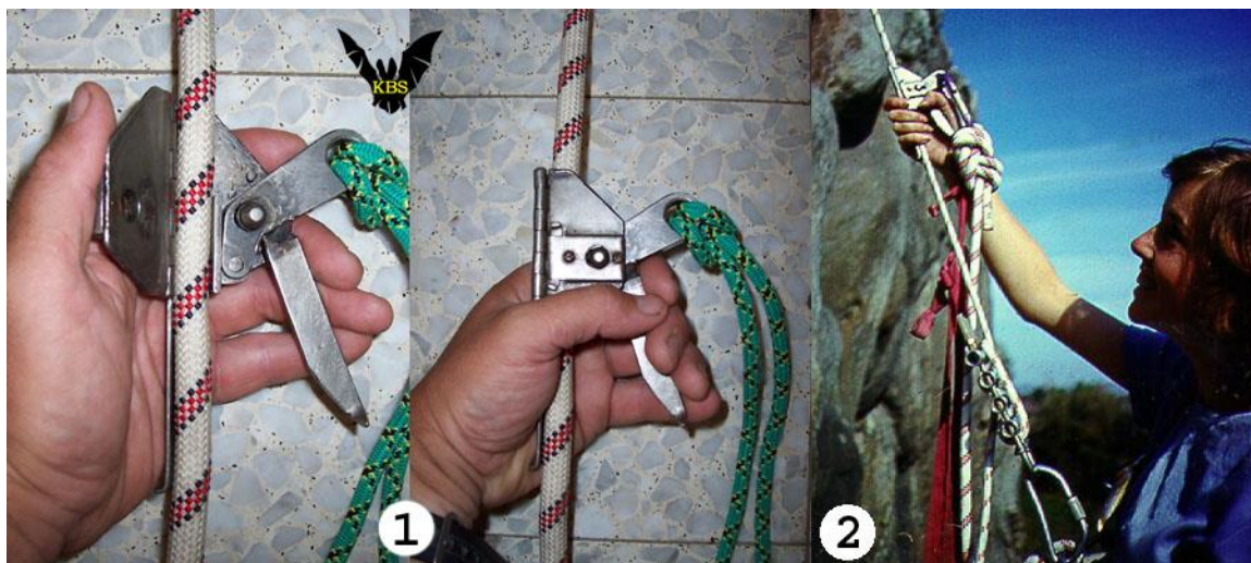
Рис.18. Универсальный (трос-веревочный) самостраховочный зажим "Рефлекс" (авторы Ш.Дюйсекин, К.Серафимов, клуб спелеологов "Сумган").
