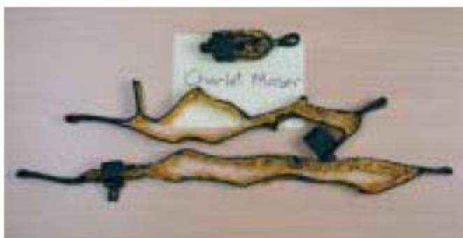
Figure 50. Charlet Moser shock absorber (показан полный сверху и развернутые внизу)
