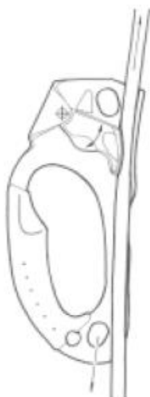
Figure 33. Типичный ручной "асендер" Типа В (грудной асендер такой же, но с маленьким корпусом и без ручки)
