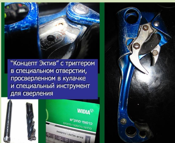
Рис. 15'. Первый триггер «Концепта», смонтированный в специальном отверстии кулачка и инструмент для таких отверстий.
