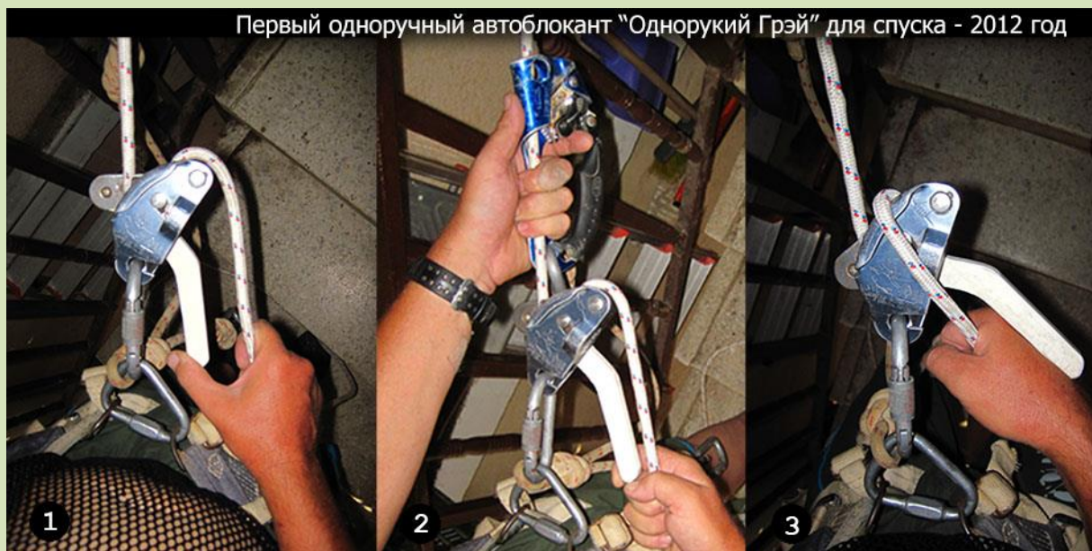
Рис.19. Варианты управления первым вариантом «Грэя» с пластмассовой ручкой: 1 и 2 – с S-образным положением веревки, 4 пальца на веревке – 1 отводит ручку; 3 – тыльной стороной управляющей руки с более надежным хватом рапели всеми пальцами и стандартным положением веревки, хотя так можно управлять и при S-образном положении.
