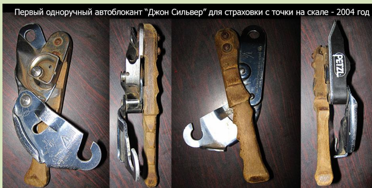
Рис.16. Первый одноручный автоблоконт «Джон Сильвер» с деревянной «рукой», 2004 год.
