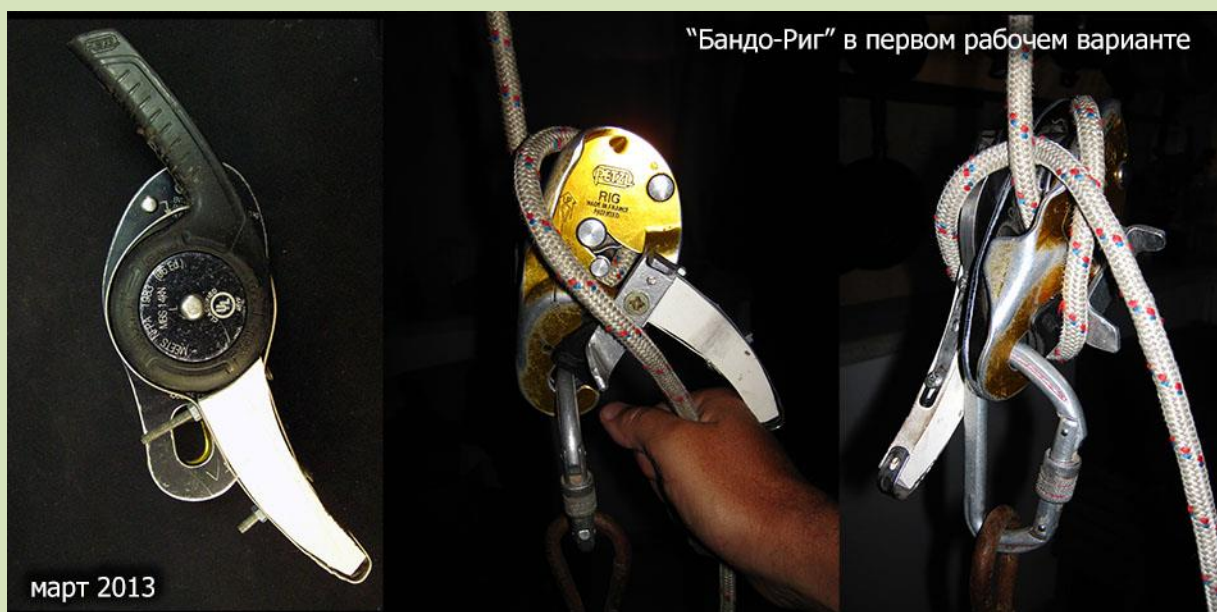
Рис.28. Из «Petzl RIG» легко получается одноручный автоблок:
