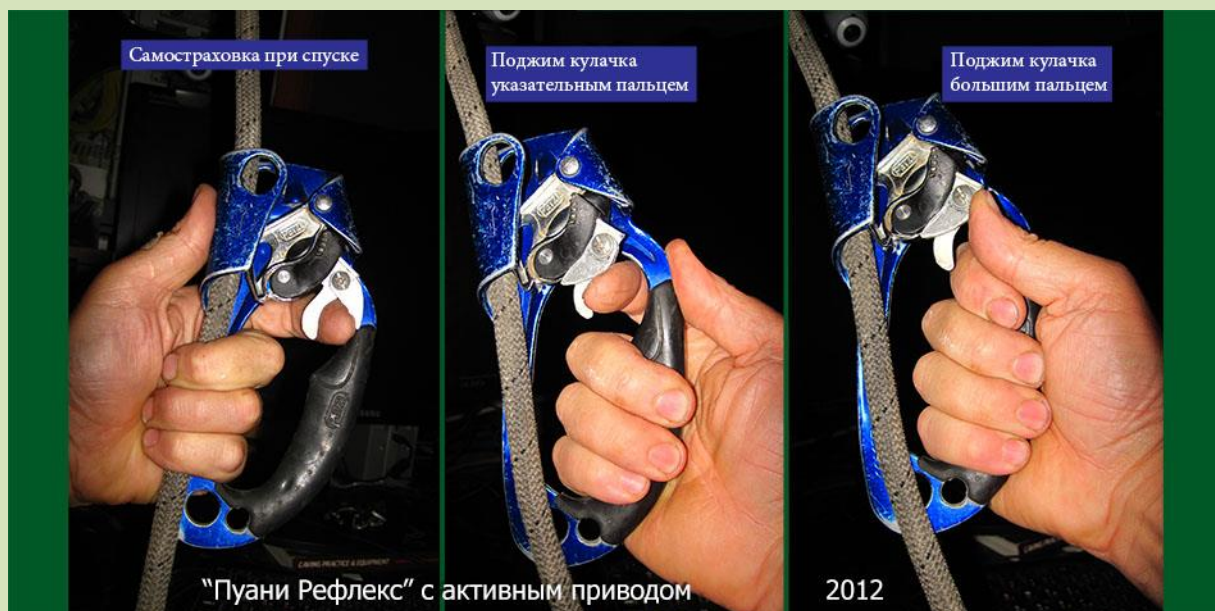
Рис. 11. Первый вариант активной скобы триггера «Рефлекс» с креплением к фиксатору кулачка.
