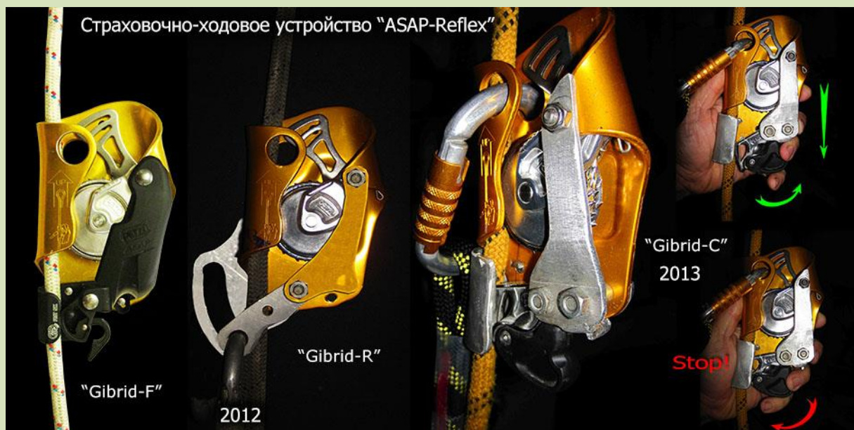
Рис.35. Разные варианты гибрида «ASAP-Reflex» с августа 2012 по февраль 2013 года:
