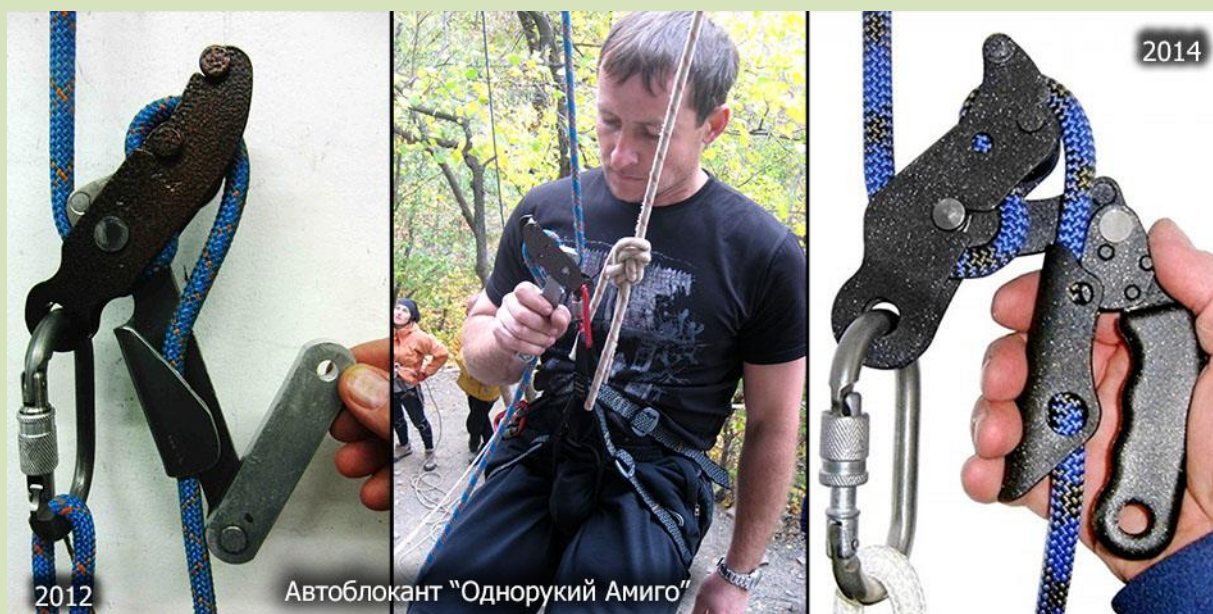
Рис.34. Автоблок «Однорукий Амиго», разработанный А.Костромитиновым, Украина: – слева – один из первых вариантов на базе «Стопор Десантёра», август 2012 года; – в середине – первые испытания 14 октября 2012 года на Кубке Памяти в п. Зуевка Донецкой области, Украина; – справа – конечный вариант на основе «Десантёра “Блэк Джэк”», поступивший в продажу в феврале 2014 года.
