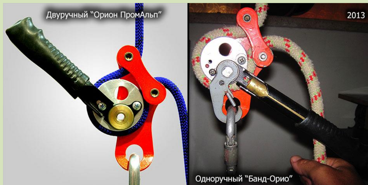
Рис.33. Одноручный «Бандорио» получается из двуручного автоблоканта «Орион Пром-Альп» простым поворотом рукоятки, 2013 год.
