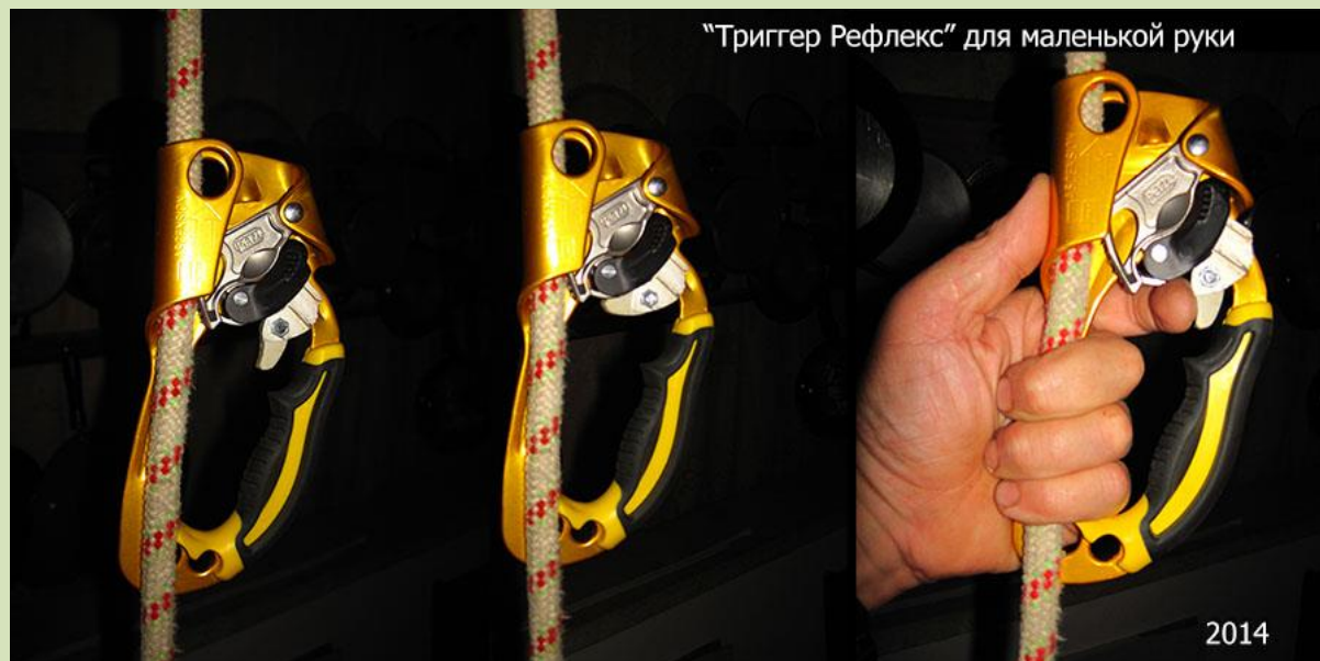
Рис.9. Триггер «Рефлекс» для более комфортного ведения маленькой рукой – для этого шарнир примыкания курка подвинут к веревке.
