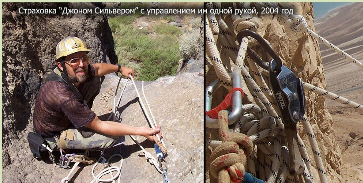
Рис.17. Замена оригинальной ручки «Petzl GriGri» с поворотом ее на 180° позволили управлять одной рукой одновременно веревкой и рукояткой, контролируя веревку сразу обеими руками, как и полагается при грамотной страховке партнера.
