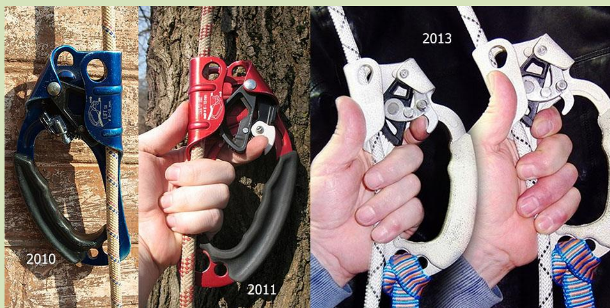
Рис.8. Триггер «Рефлекс» других авторов на разных зажимах:
