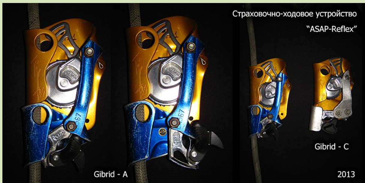
Рис.37. Страховочно-ходовое устройство « Гибрид » – вариант из « Petzl Ascension », февраль 2013.
