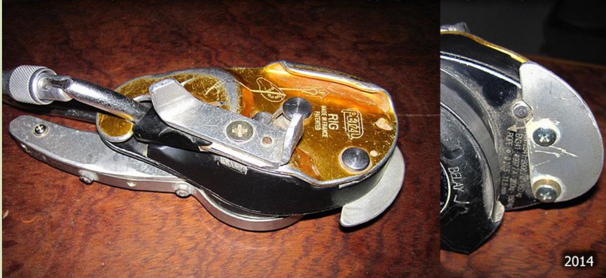
“Бандо-Риг” - ограничитель соскакивания и накладка на ручку для S-заправки веревки
