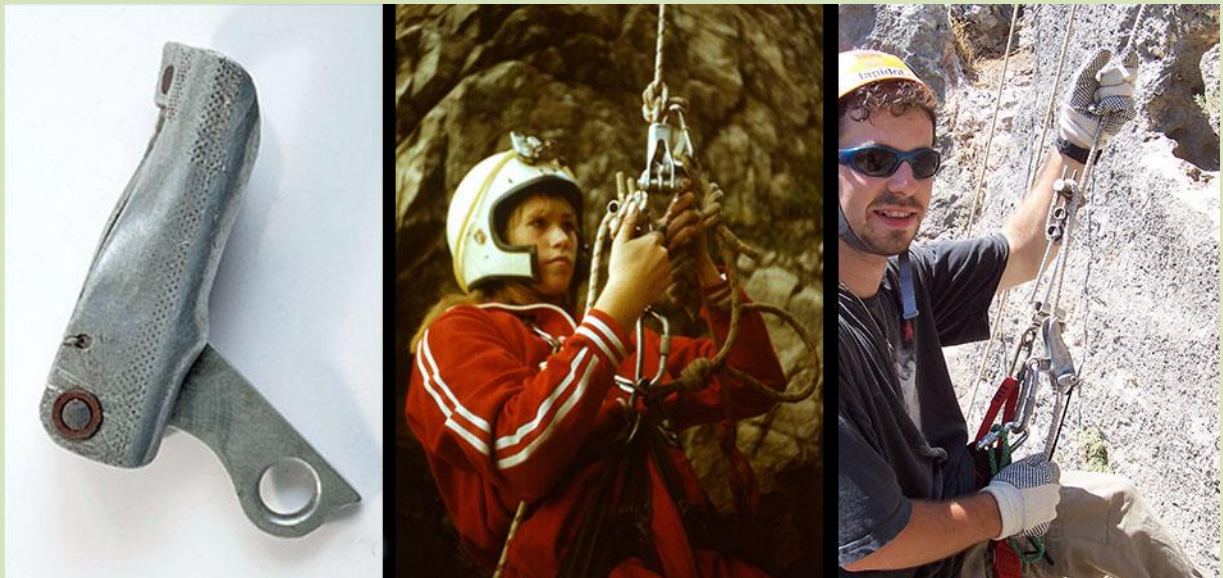
Рис.56. Первый в мире специальный зажим для самостраховки при спуске – «Shunt» Ферно Петцля:
