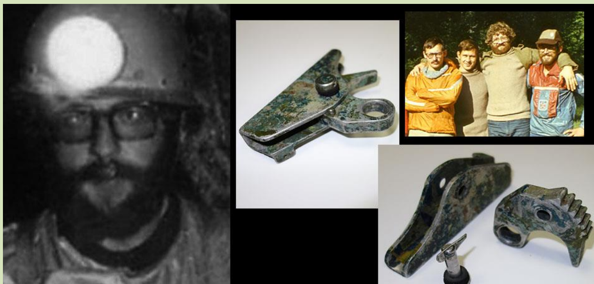
Рис.60. Андрей Пильский, Москва, в 1983 году предложил модификацию «Снежинского гиббса» для использования для самостраховки по веревке (так как спелео-группа «Снежная» в это время использовала исключительно веревки), получившую название «Снежинский рефлексовый» зажим.
