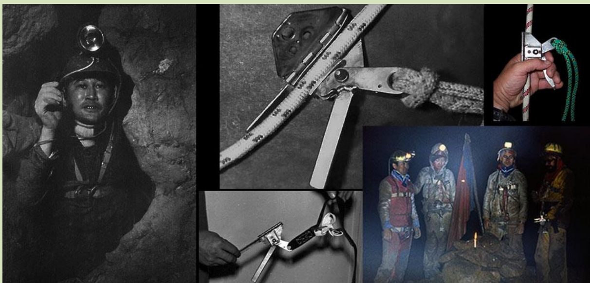
Рис.61. Шынгыс Дюйсекин, Усть-Каменогорск, в 1983 году создал универсальный тросово-веревочный страховочно-ходовой зажим, который и дал название самому Принципу и всему классу подобных конструкций:
