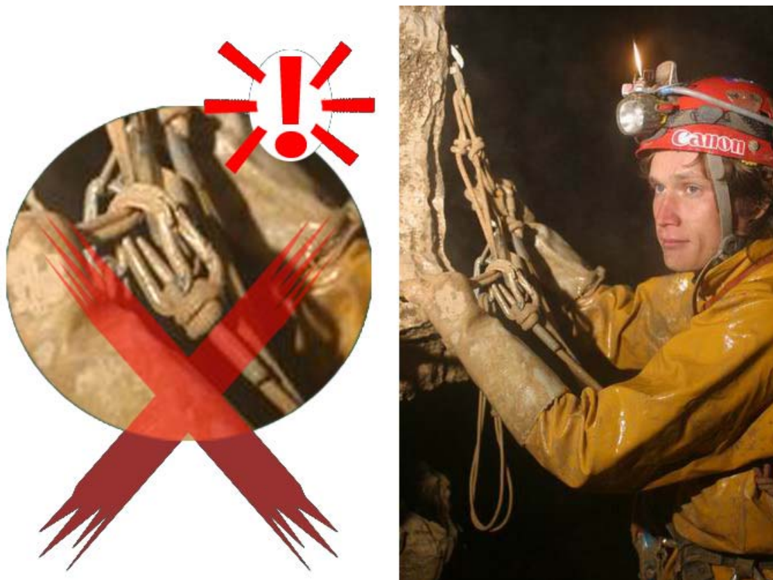
Рис.15. Пример использования участниками экспедиции в пещеру Крубера-Воронья 2005 года «британского Баррела» со слишком короткими кончиками и негодным карабином на конце короткого страховочного уса. Фото с сайта http://www.cavexclub.ru/
