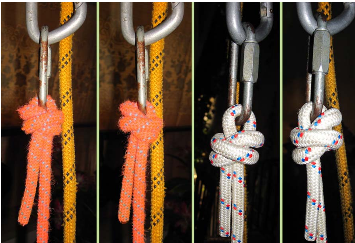
Рис.20. Поведение «британского Баррела» при затягивании весом человека на мэйлон рапиде «GO» диаметром 7 мм. Ни о каком «втягивании карабина» или «натягивании бочонка» речи не идет, а до свободного кончика нагрузка через «бочонок» просто не доходит.
