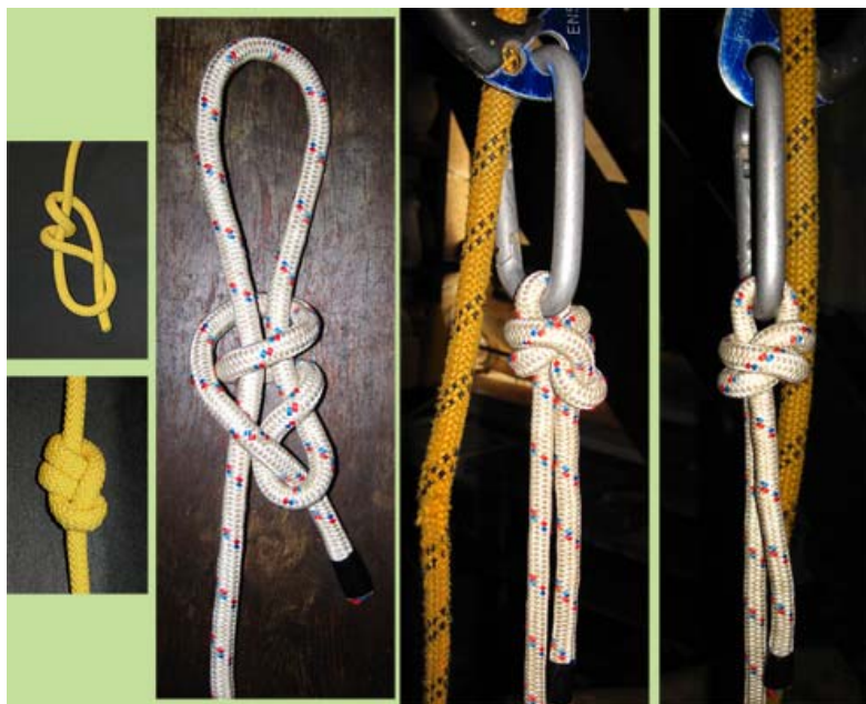
Рис.42. Петля на карабине с узлом «Стивдор» в качестве «бочонка». Справа для сравнения размеров удавка с «британским Баррелом».
