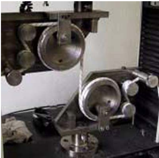
Рис.34. Фото 60 из «Отчета» 2001 года, стр.113: Кабестанное устройство для испытаний образцов веревок ( Capstan arrangement used to break rope samples ).
