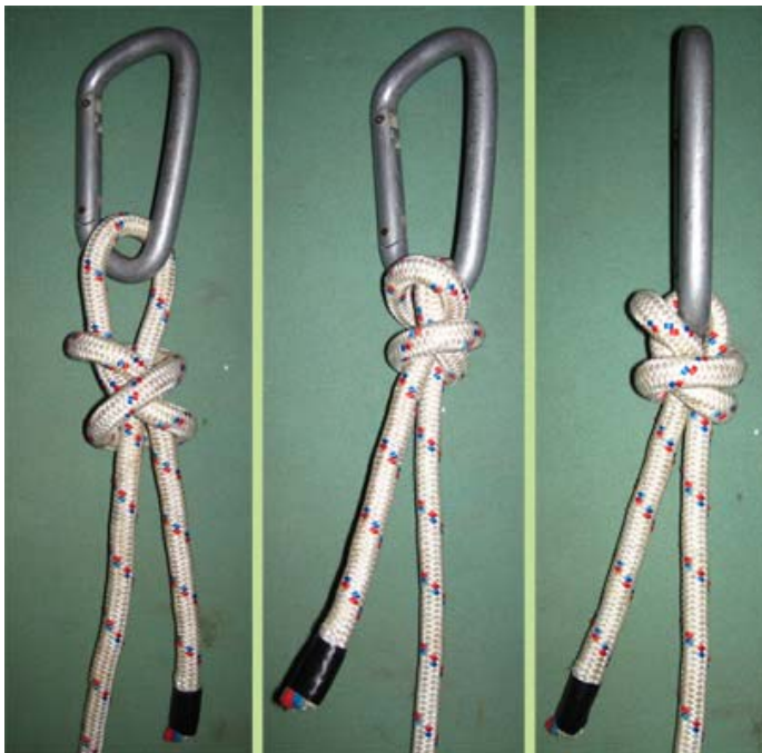
Рис.27. Результат приложения нагрузки к усу с незатянутым «бочонком».
