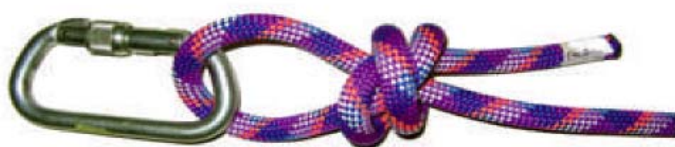
Рис.29. Этап 2: Затягиваем полученную скользящую петлю так, чтобы она плотно охватила карабин.
