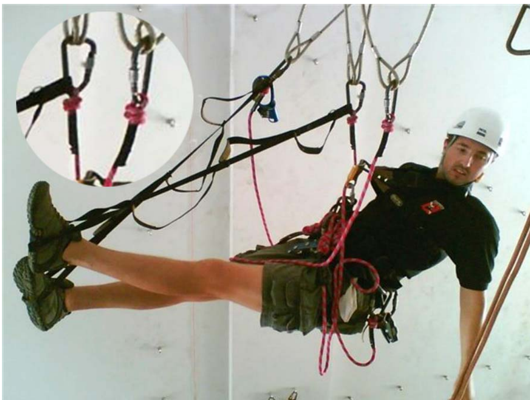
Рис.25. Обматывание кончиков изолянткой лишает их гибкости и препятствует непроизвольному развязыванию «бочонка», фото из Темы «Усы самостраховки: конфигурации, способы вязки, энергоёмкость» ( http://www.promalp.ru/viewtopic.php?f=13&t=26025 )
