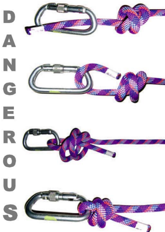
Рис. 31. Два способа неправильного завязывания «британского Баррела».
