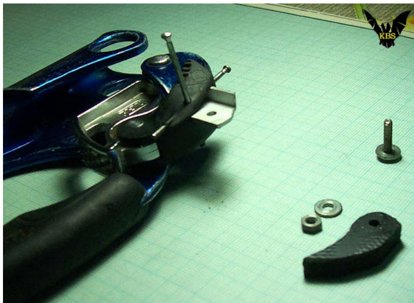
Рис.8. Крепление уголка в отверстии фиксатора зажима с помощью 2 шпилек диаметром 2 мм.
