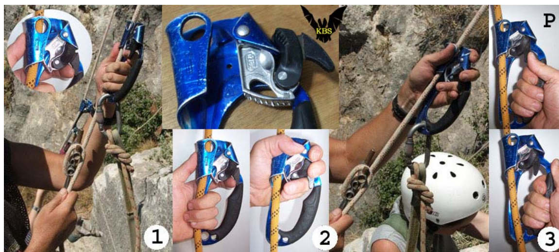
Рис.3. Самостраховочный эксцентрик с курком "Reflex" на основе пуани Петцля.
