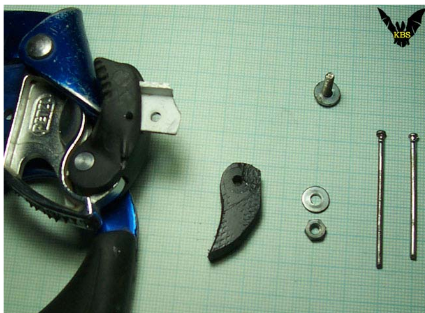
Рис.7. Нормальное положение уголка в отверстии фиксатора зажима.
