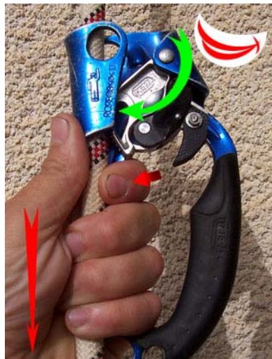
Рис.12. Срабатывание зажима, оснащенного курком "Рефлекс" под действием хватательного рефлекса в момент утраты контроля над спуском.
