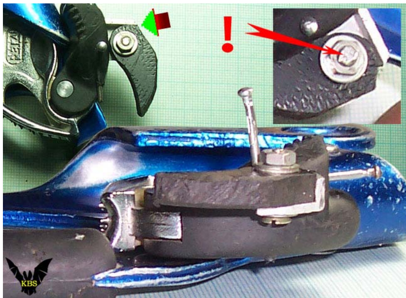
Рис.9. Присоединение курка к уголку с помощью болтика диаметром 3 мм.
