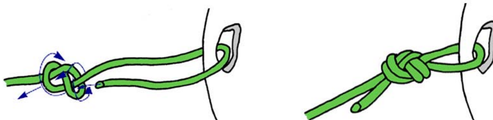
Вязывание узла "Восьмерка" в проушину встречным способом вязки.
