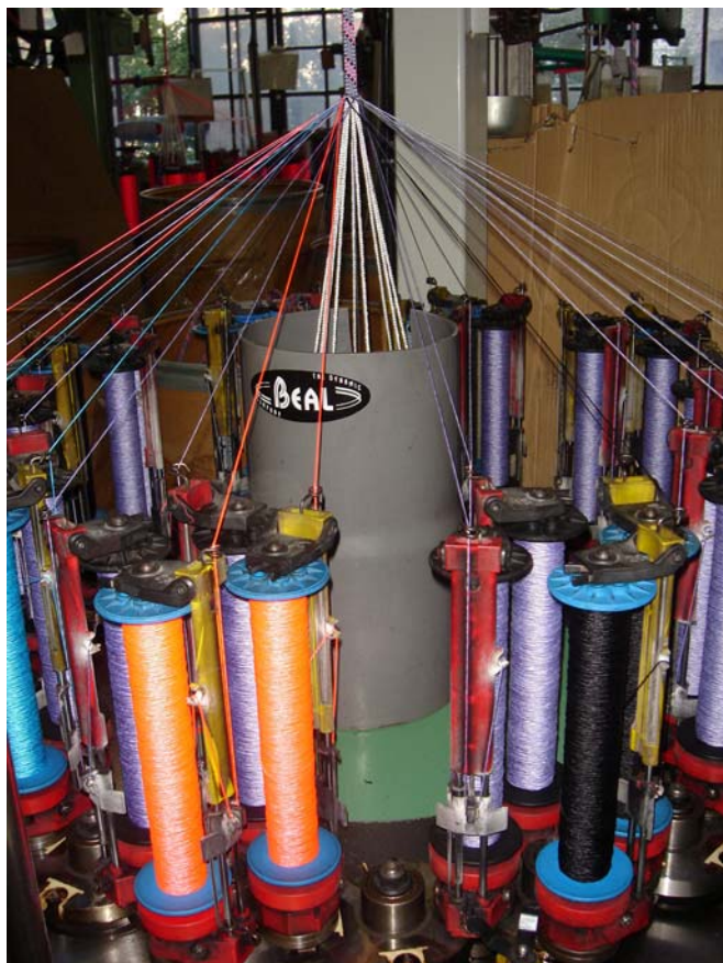
Кабельная веревка в процессе изготовления (Вебсайт фабрики "Beal")
