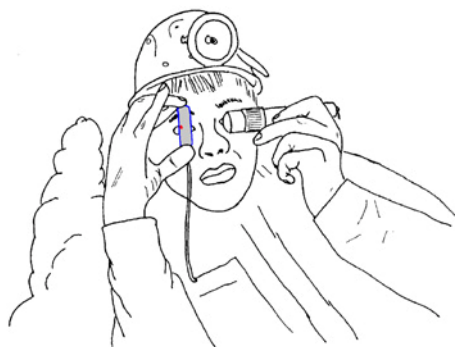
Считывание клинометра "Suunto"
