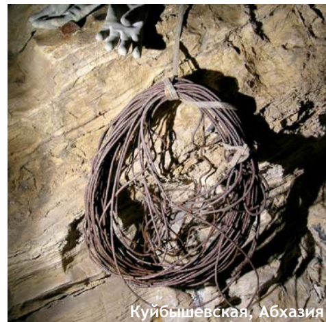
Трос 6 мм, с которым могут быть использованы только рэки.
