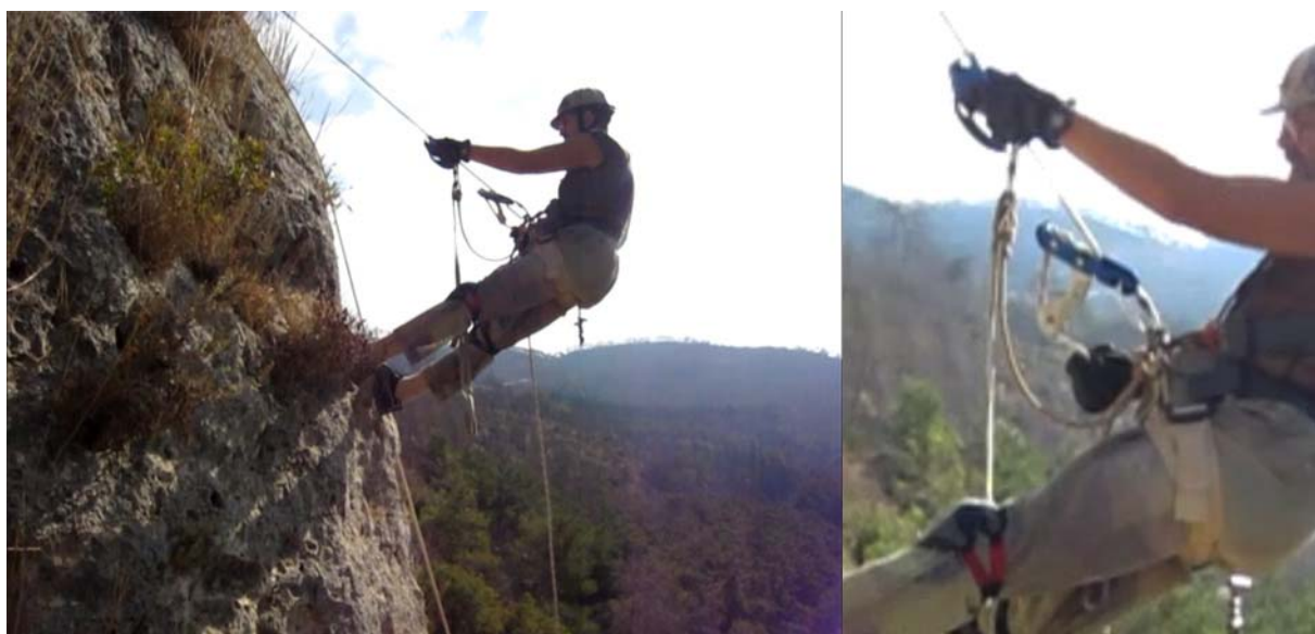
Рис.50. Притормаживание рапелью, перекинутой через ролик сверху: натягивая веревку, мы заставляем эксцентрик прижимать ее в устройстве и этим увеличиваем торможение.
