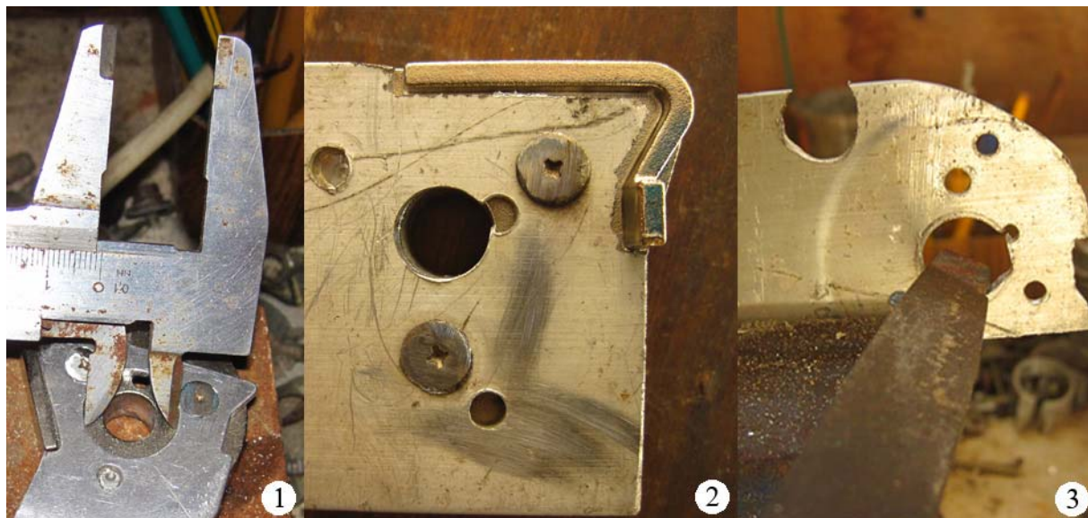
Рис.23. Пропиливание отверстия под пружинку – самая трудоемкая часть изготовления, как шаблона, так и любой рукоятки «БандоСтопа»:
