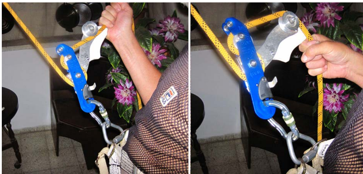
Рис.76. Два способа управления «Рукояткой» третьей версии «Ок» с «крылом»: с веревкой под роликом (слева) и веревкой над роликом (справа). Последний способ можно перевести в притормаживание эксцентриком, просто изменив усилие натягивания веревки рукой.
