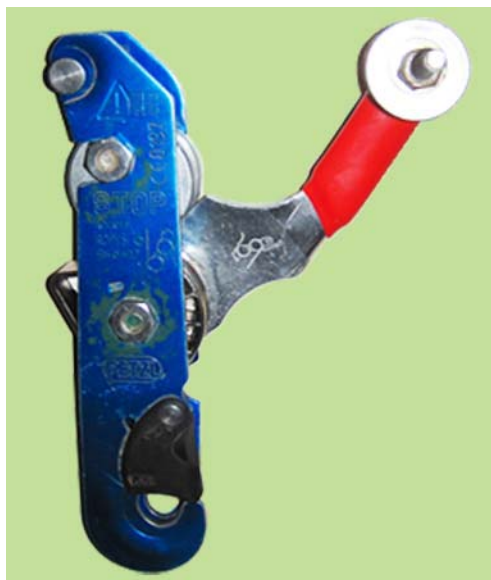
Рис.35. Первый ролик у «Краснорукого» был небольшого диаметра: Внешний диаметр – 31,5 мм, внутренний - 23 мм.
