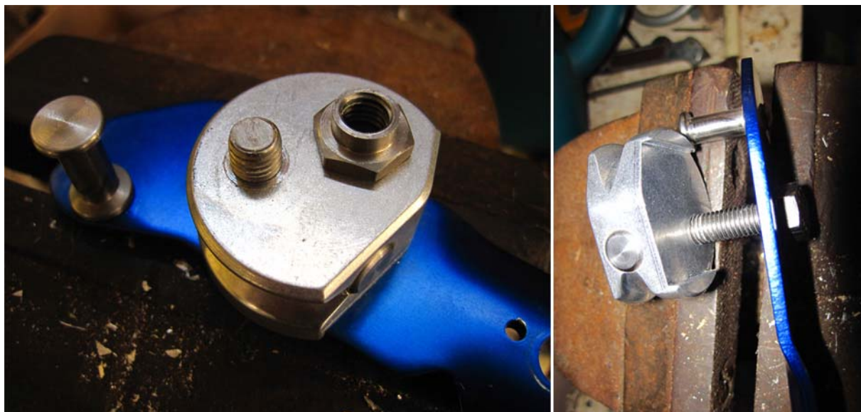
Рис.30. Демонтаж верхнего фрикциона « Petzl Stop ».
