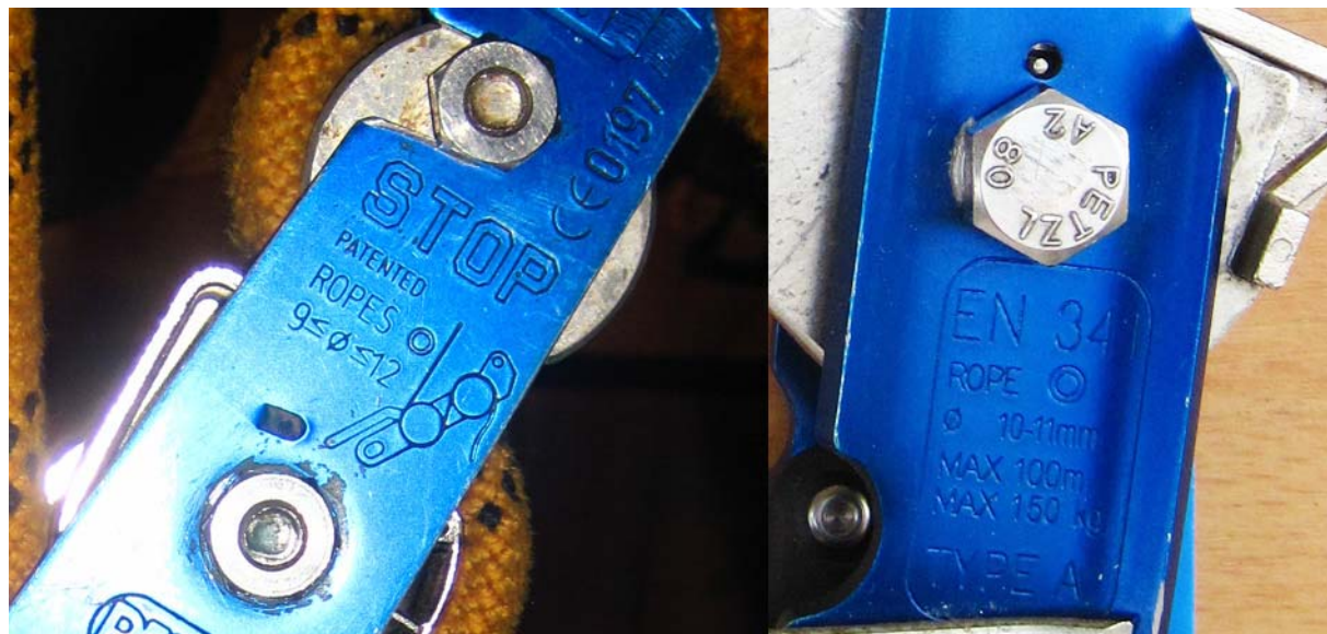
Рис.83. Диаметры веревок, предназначенные производителем для спуска на «Petzl Stop»: Слева – маркировка на лицевой поворотной пластине корпуса. Справа – маркировка на задней пластине корпуса.
