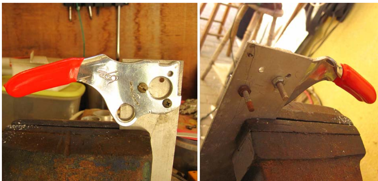
Рис.22. Начальная фаза изготовления шаблона для будущих ручек «БандоСтопа» по оригинальной рукоятке, но повернутого под углом 90° к ней.
