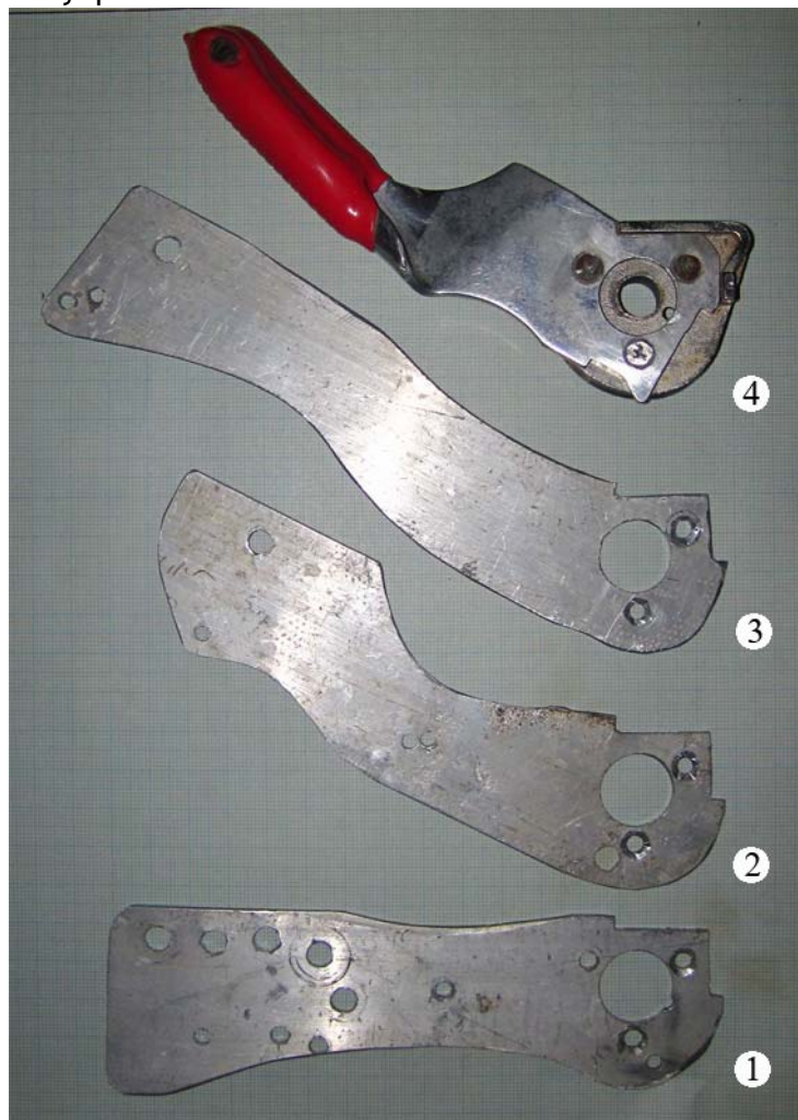
Рис.75. Сравнительная форма рукояток для «БандоСтопа», которые я сделал к моменту написания этой работы:
