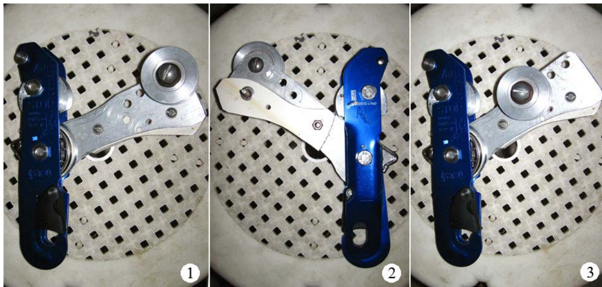
Рис.33. Первая версия «БандоСтопа» со специальной рукояткой:
