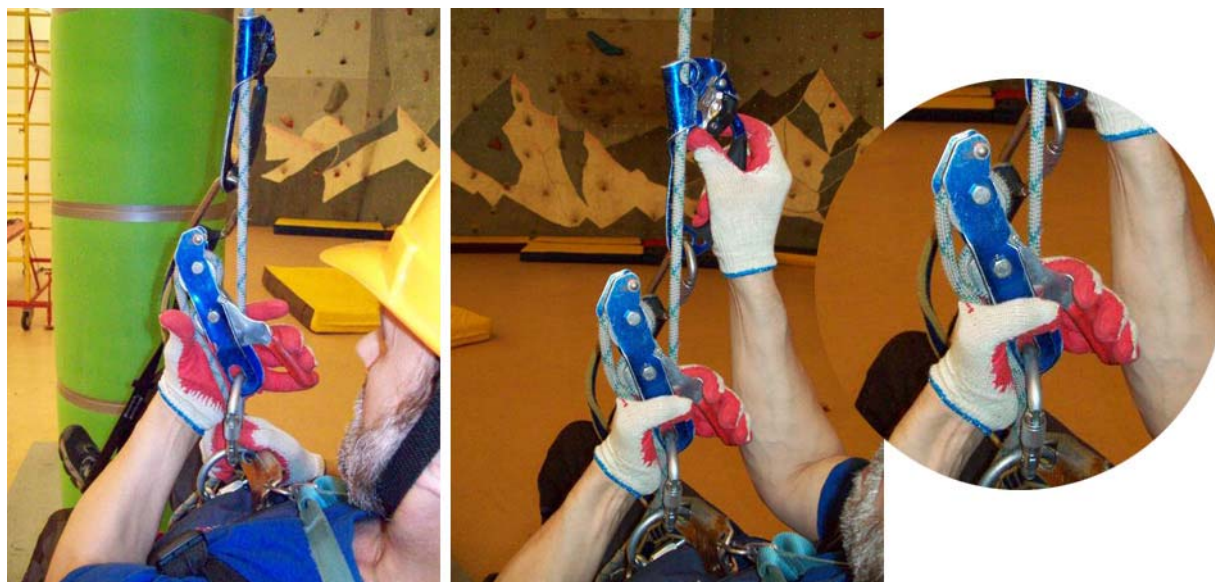
Рис.9. Способ спуска на «Petzl Stop» с управлением одной рукой и ведением самостраховочного зажима другой, предложенный Михаилом Алексеевым, Иркутск, в 2008 году.
