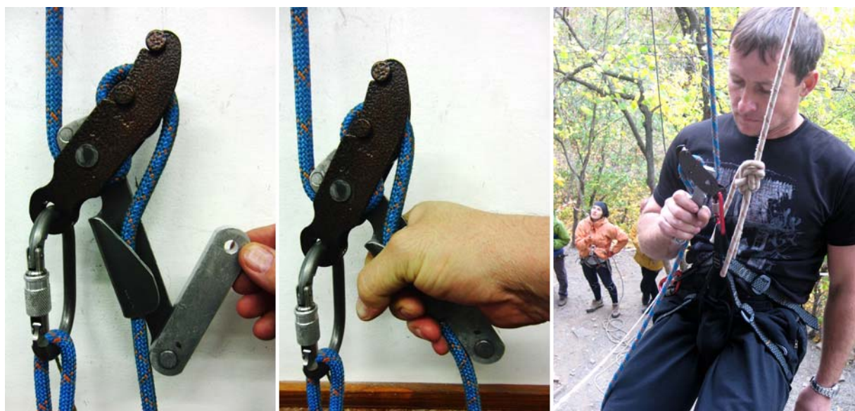
Рис.77. «Однорукий бандит Амиго», разрабатываемый Алексеем Костромитиновым на базе его предприятия «Крок», г.Стаханов, Украина, вообще не имеет ролика и управляется только с помощью рукоятки, которая позволяет вообще не касаться рапели рукой.
