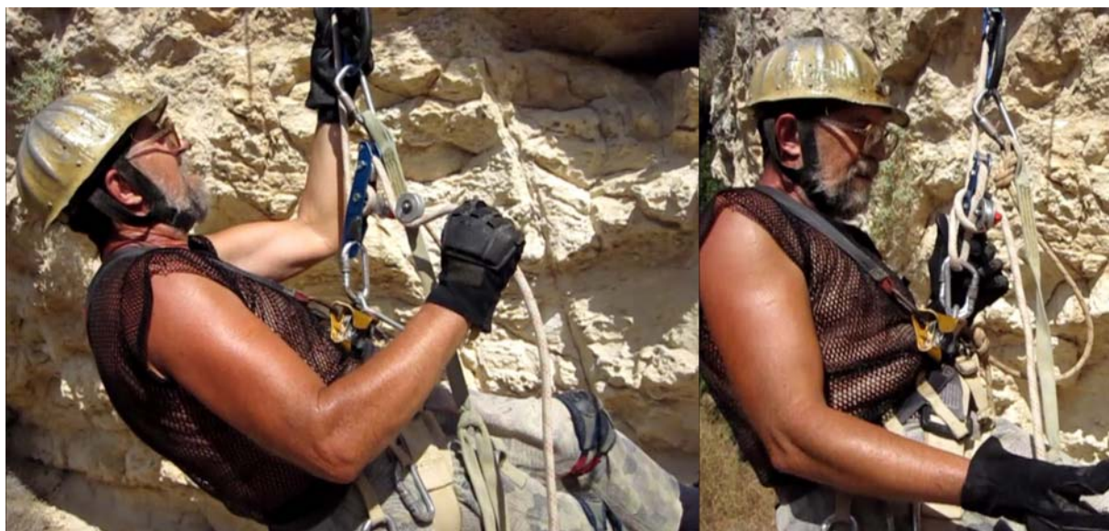
Рис.43. Фиксация «бандостопов» летних версий была невозможна без дополнительного карабина на беседке – аналогично прототипу.
