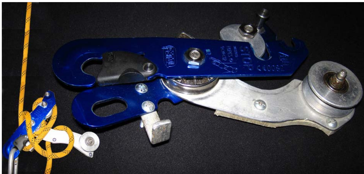
Рис.51. Нижний рог для обеспечения фиксации веревки в «БандоСтопе» без дополнительного карабина.
