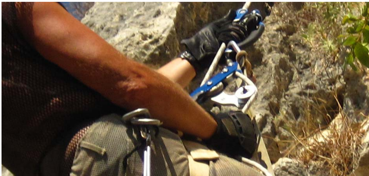
Рис.80. Притормаживание эксцентриком с помощью рапели, положенной на ролик сверху на очень скользких веревках. Вторые полевые испытания на скалах 15 сентября 2012 года.
