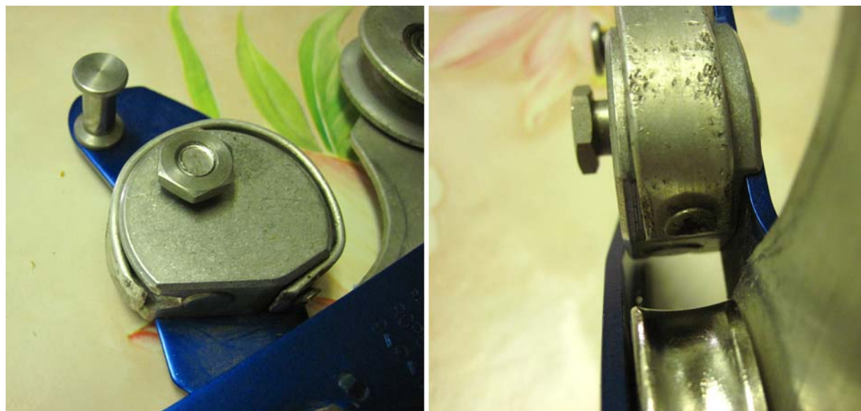
Рис.44. Накладка на верхний фрикцион , которую я сделал, чтобы увеличить его диаметр и убрать канавку. Получившийся диаметр 46,5 мм.
