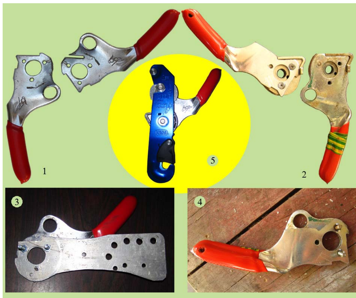
Рис.24. Переделка оригинальной ручки с поворотом ее на 120^\circ против часовой стрелки:
