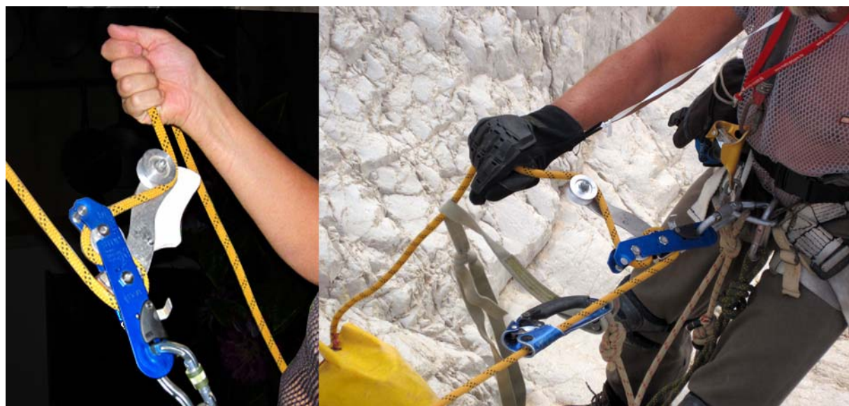
Рис.78. Управление «Рапелью» дает нам возможность располагать управляющую руку на разных расстояниях от «бандита», а также спускаться, вообще не касаясь рукоятки рукой.
