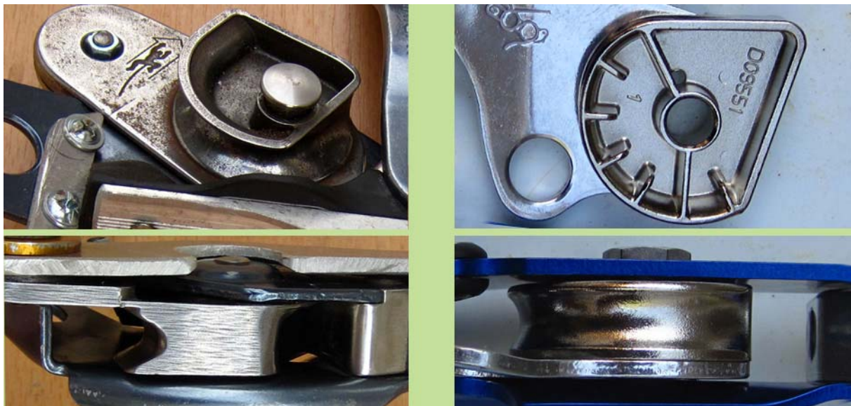
Рис.84. Форма фрикционов «Petzl GriGri» (слева) и «Petzl Stop» (справа) – различия видны невооруженным глазом.
