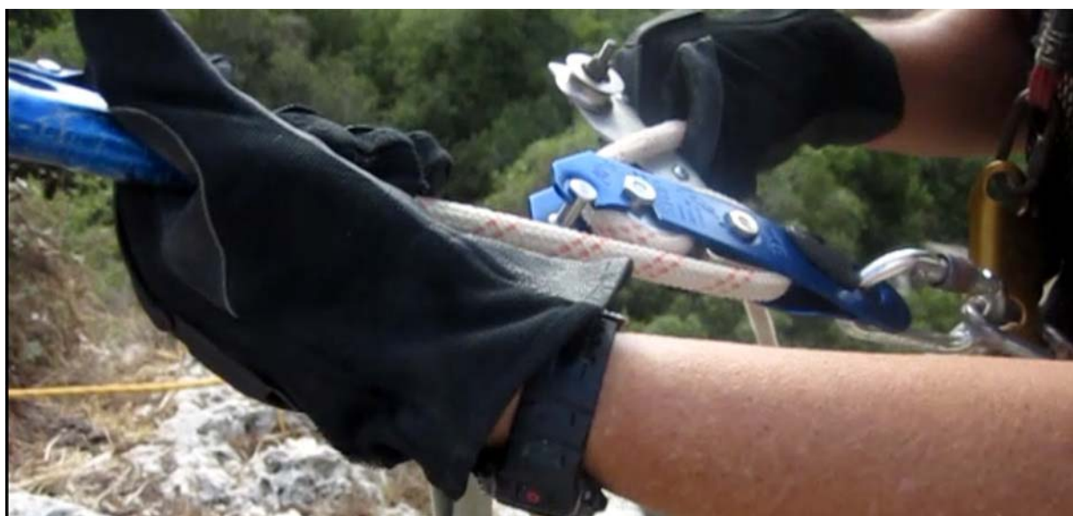
Рис.40. Третий спуск на «Белоруком брате» по 13-миллиметровой веревке сразу показал, что он идет хуже: новый верхний фрикцион, маленький ролик, менее выгодные размеры – все это дает ощутимую разницу при спуске по одной и той же одинаково висящей веревке.
