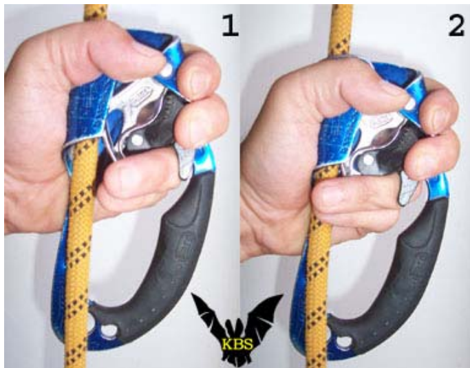
Рис.82. Управление курком безымянным пальцем. Этот вариант удобнее при ведении зажима "Basic" без ручки.
