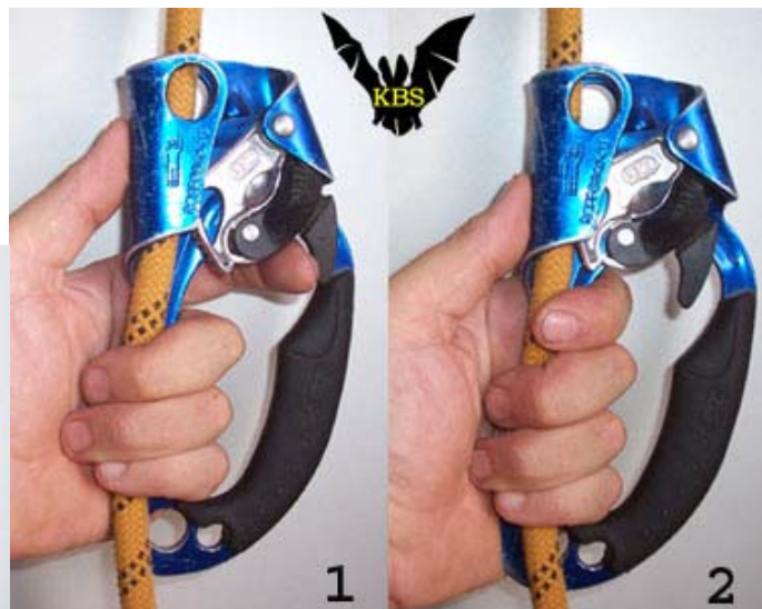
Рис.82. Управление курком безымянным пальцем. Этот вариант удобнее при ведении зажима "Basic" без ручки.
