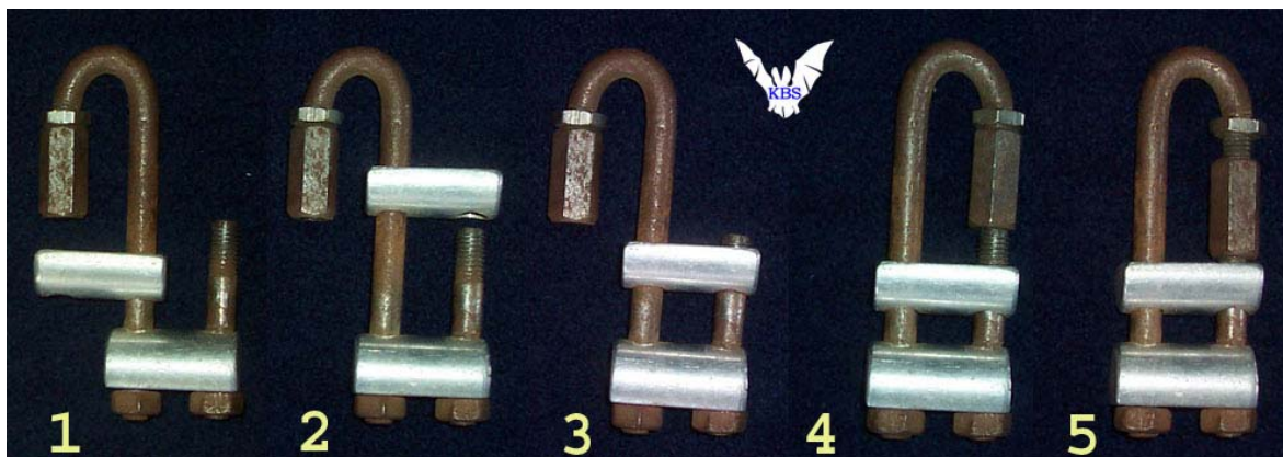
Рис.95. Фазы работы "АКС-М" для закрепления в нем веревки (не изображена).
