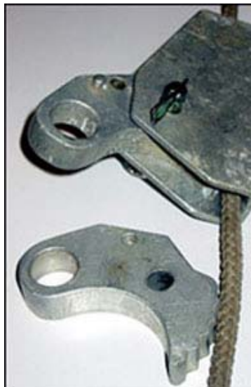
Рис.59. Преимущественно точечный прижим линейной опоры из коллекции А.Шелепина (фото с сайта "Снежная")
