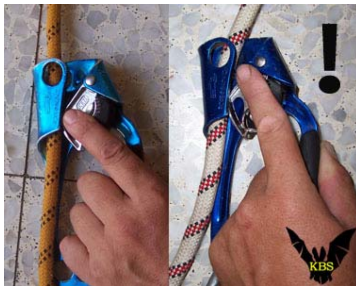
Рис.80. Правильное (слева) и опасное (справа) положение указательного пальца на кулачке относительно защелки
