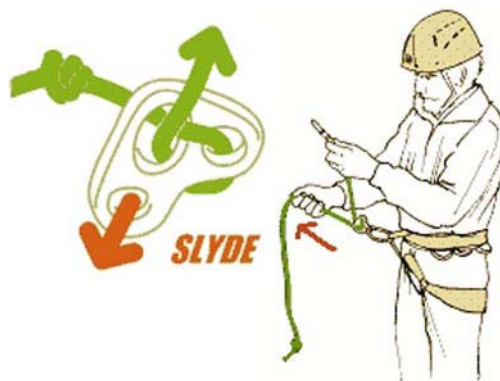
Рис.22. Амортизатор "Slide" и возвращение веревки для протравливания.
