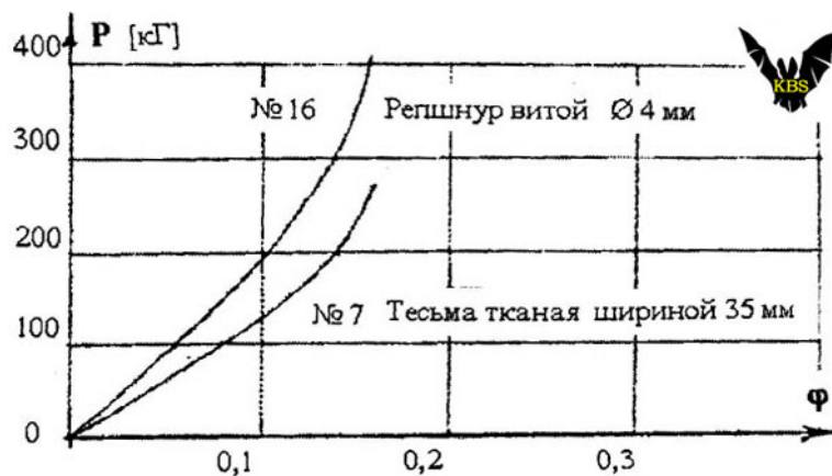
Рис.92. Механические характеристики шнура витого диаметром 4 мм и синтетической ленты шириной 35 мм
