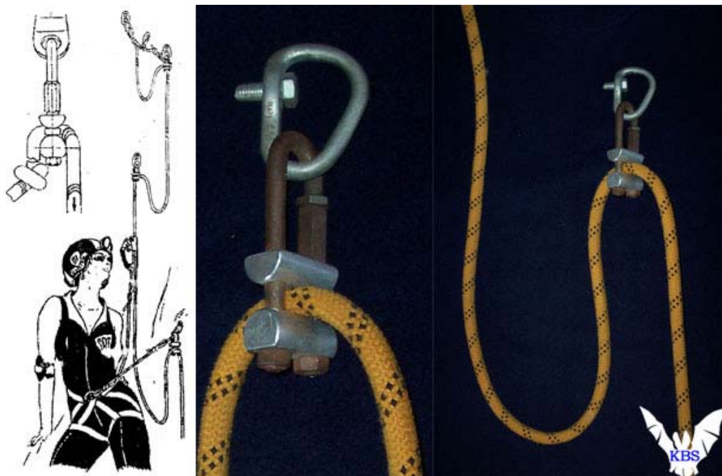
Рис.93. Амортизирующий карабин Серафимова (АКС-М)
