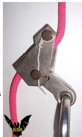
Рис.52. Положение зажима типа Gibbs после приложения нагрузки
