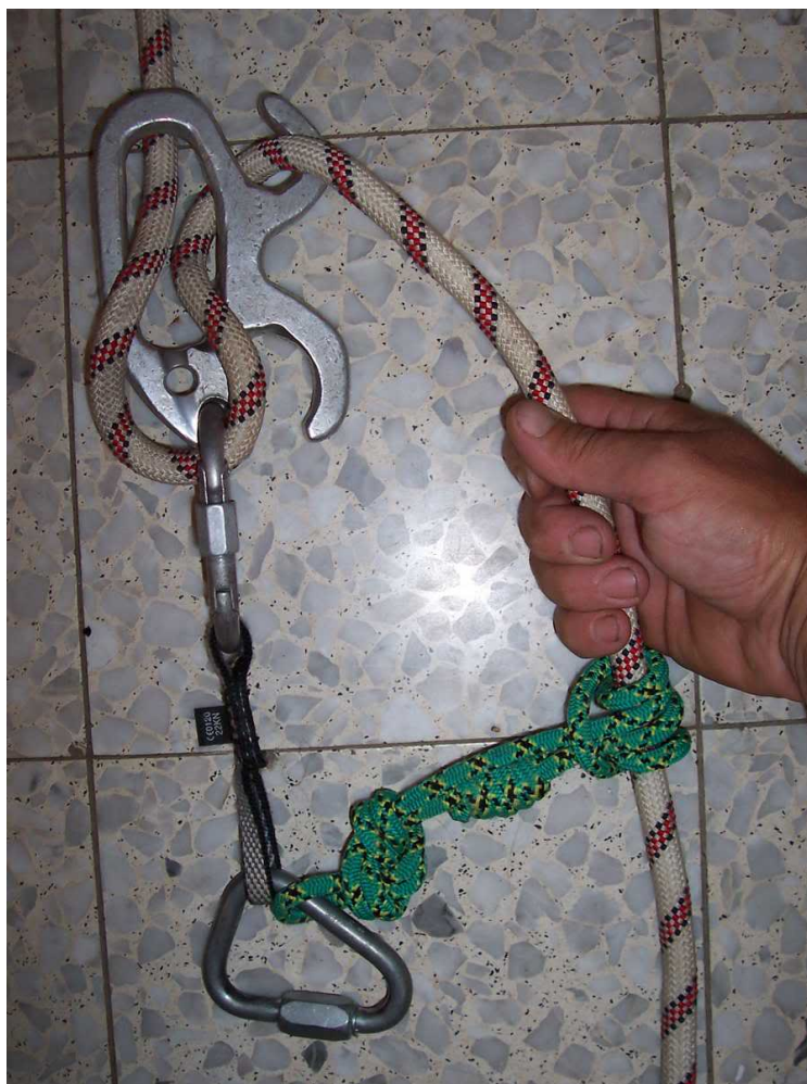
Рис. 16. Самостраховка схватывающим, расположенными под ФСУ.
