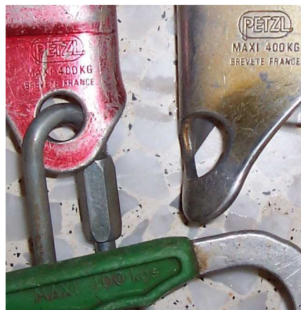
Рис. 27. Прочности зажимов 400 кг вполне хватает для большинства операций.
