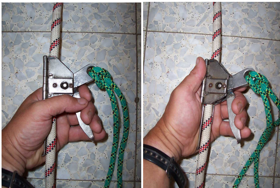
Рис. 24. и 25. Универсальный самостраховочный зажим „Рефлекс“.
