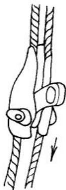
Рис. 10. Зажим „Шант“ обратного принципа прижима.
