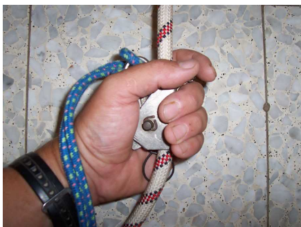
Рис. 17. Смертельно опасный хват зажима типа Гиббс.
