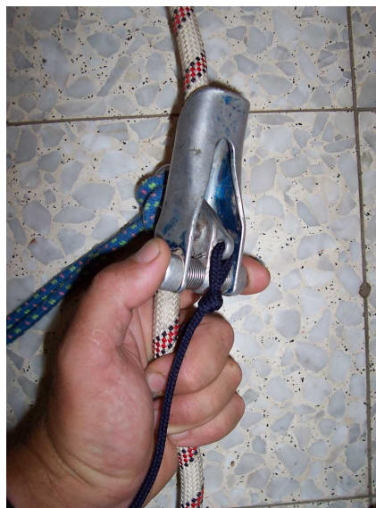
Рис. 21. Правильное ведение зажима «Шант» за бобышки корпуса.
