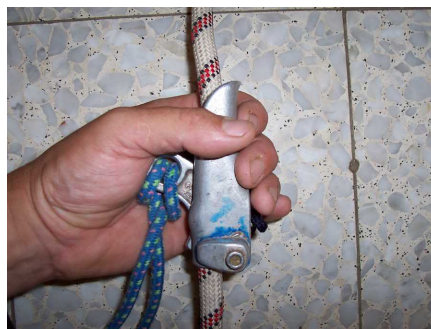
Рис. 18. Не менее опасный хват зажима „Шант“.
