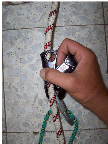
Рис. 29. Ведение зажимов типа „Бэйсик“ для самостраховки на спуске.
