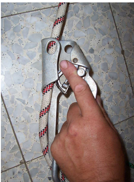
Рис. 30. и 31. Варианты безопасного ведения зажимов типа "Жумар".
