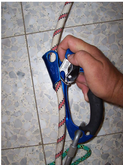
Рис. 28. Ведение зажима типа „Жумар“ для самостраховки на спуске.
