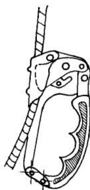
Рис. 15. Рычажно-эксцентриковый зажим Конг (Италия)
