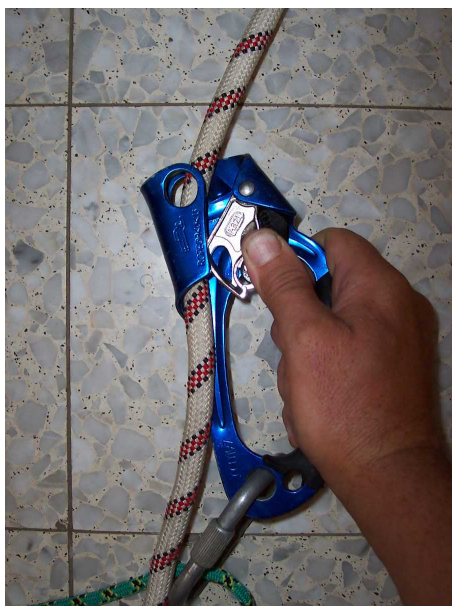
Рис. 30. и 31. Варианты безопасного ведения зажимов типа "Жумар".
