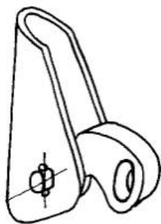
Рис. 6. Рычажный зажим „гиббс“ (соединительные цепочки не нарисованы)
