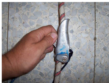
Рис. 20. Правильное ведение зажима «Шант» за кулачок.
