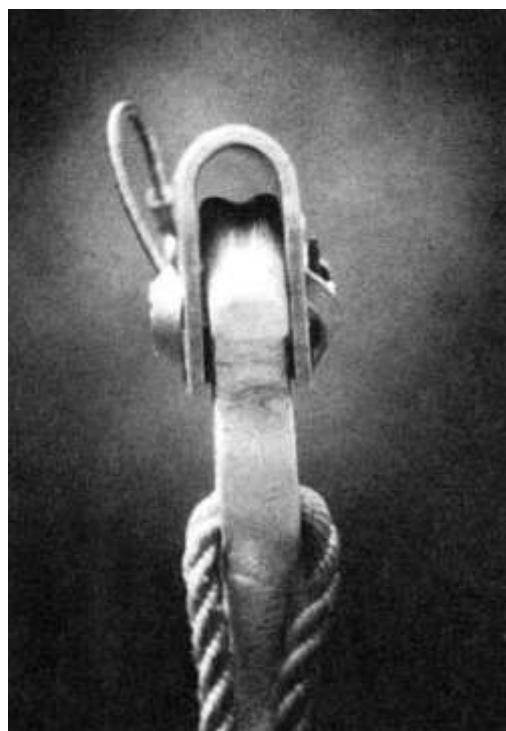
Рис.4. Просвет между кулачком и корпусом. Обратите внимание на канавку в прижимной части поверхности кулачка.
