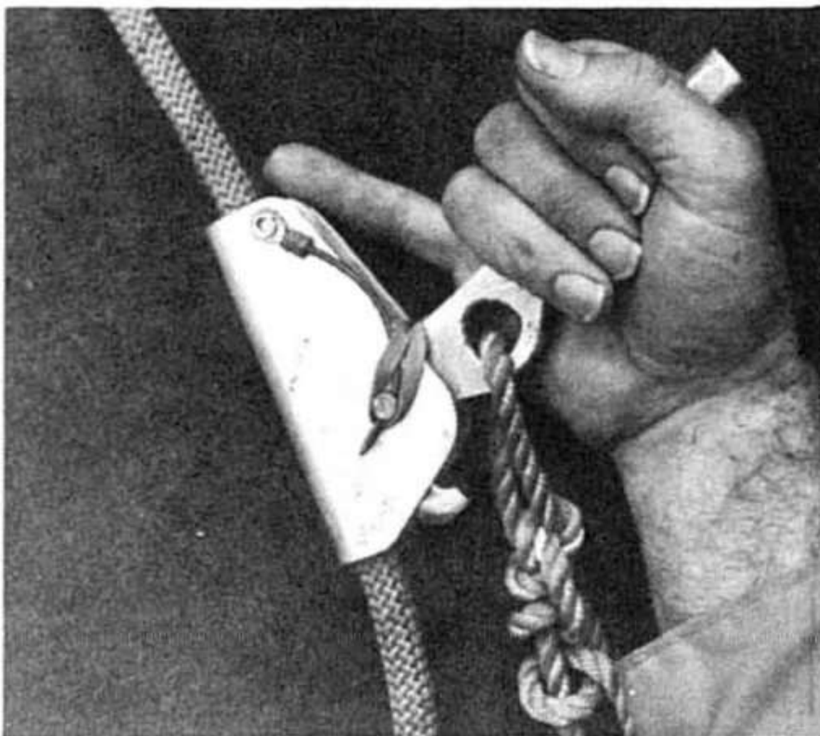
Рис. 2. «Рычажный зажим Чарльтона» (Charlton's levered cam) с удлиненным рычагом кулачка в корпусе «Гиббса».
