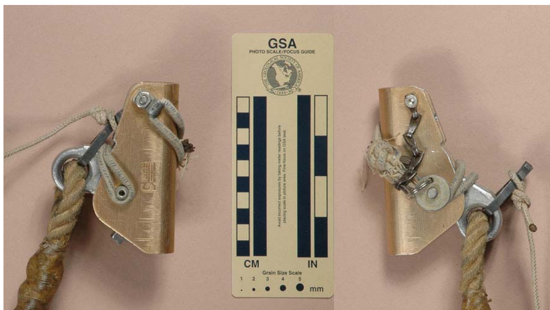
Рис.9. «SRCam» Гари Д.Сторрика: слева во взведенном состоянии, справа – сработавший.
