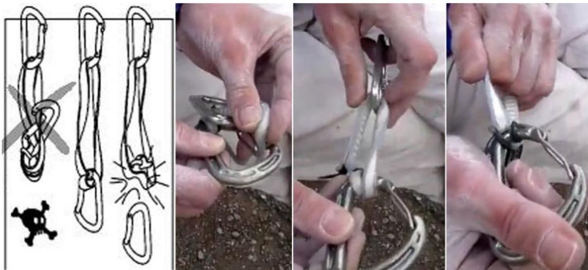
Рис.8. Механизм выстегивания кольцевого slingа из карабина:
